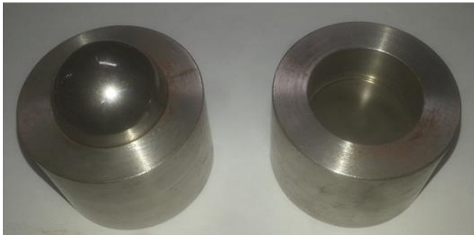
Ilustración 22. Articulación de muy bajo rozamiento.
